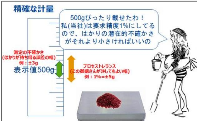
この若干セクシーなガールが、台はかりの上に試料を載せています。はかりの表示計には 500g と表示されています。前回、メトラー・トレドに校正を依頼した際に、その校正証明書に不確かさの記載があって、500g には±3g の不確かさが含まれているという情報があった。このガール、優秀極まりなく既に許容誤差範囲（許容管理幅）を規定していたようで、その範囲は 5g にしていたという。結果、
