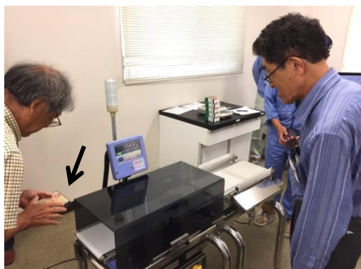
左図：被計量物を狙いを定めて重量選別機の左側から載せる・・・右図：瞬く間に計量完了！
