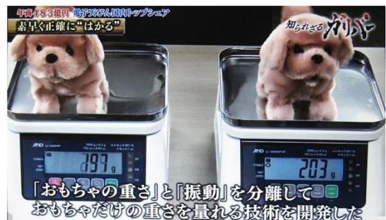
図2：振動を相殺し静止時の重さを測れるはかり(右)
