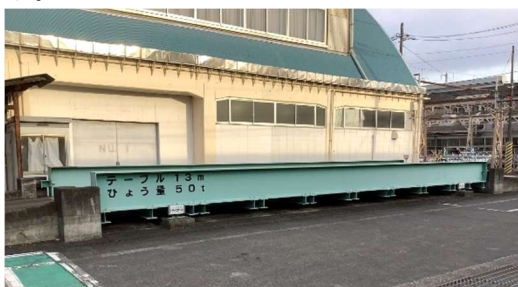
▲50tトラックスケール（日本製衡所製） （廃棄車輪等を積んだトラックの計量を行う）
