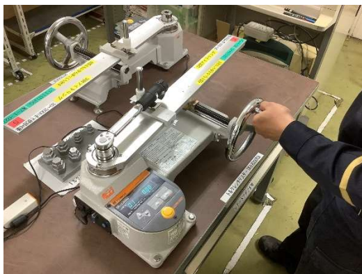
▲ トルクレンチの校正作業 (計量管理室で社員が校正しています)
