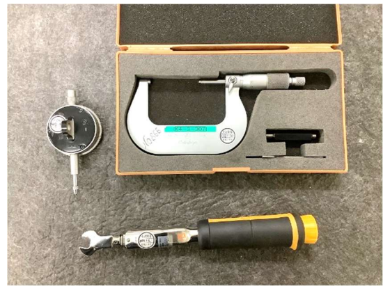
▲ 各計測器に有効期限の管理シールを貼付 (有効期限が一目で分かるように表示している)
