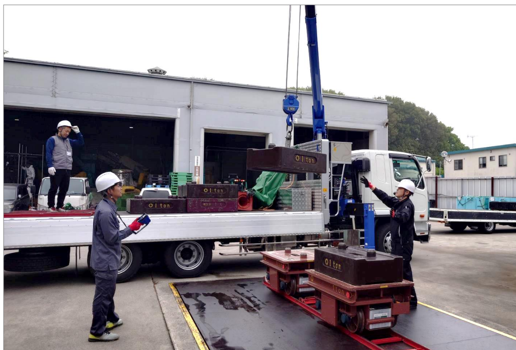
【新しい検重車を使用して定期検査を行う計量士】
